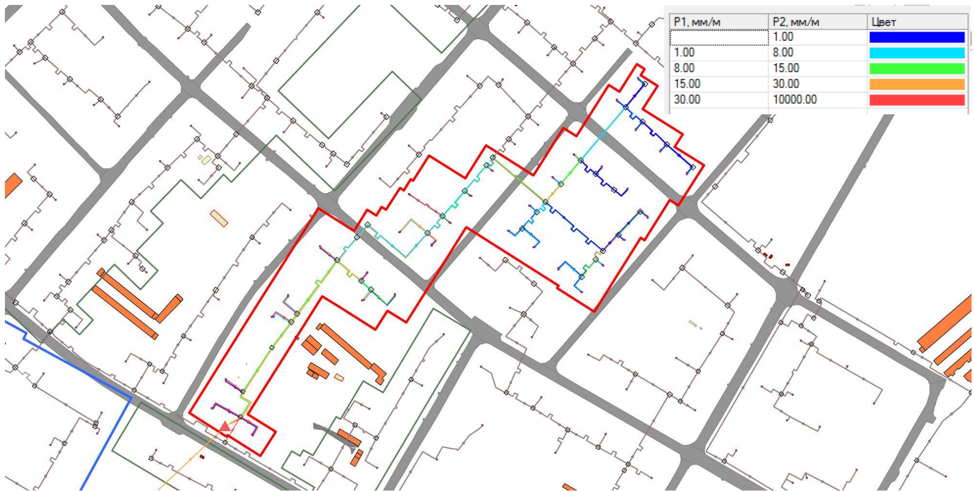
Рисунок 9-4 Расчетная схема удельных потерь напора тепловой сети - Зона действия ЦТП-3 при 4-х трубной системе ГВС
